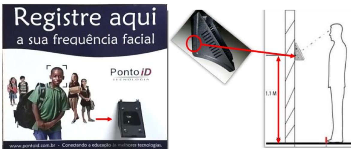
Imagem 3 - Indicação lateral do suporte e exemplo de altura recomendada para instalação.
